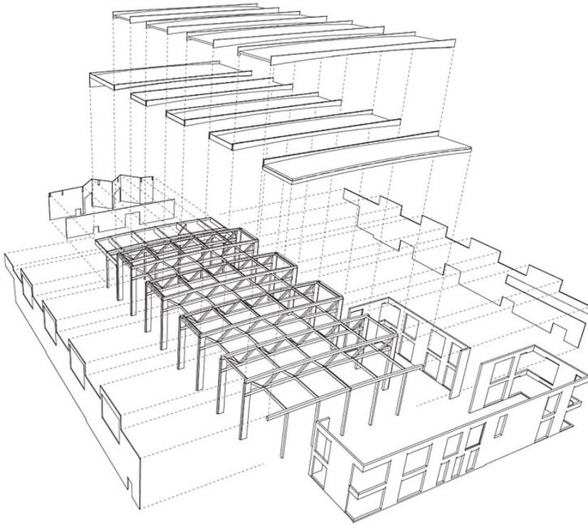
Projekt Stahlcon\_Explosionszeichnung Holzbauteile
