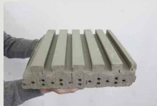
Gepresste Lehmziegel aus dem eigenen Aushub für Fußboden
