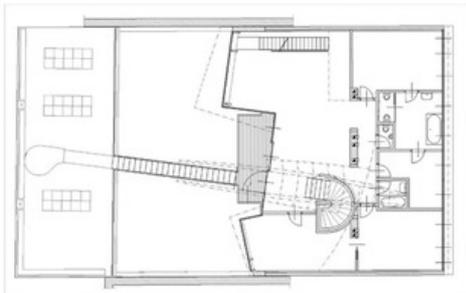
Grundriß des Dachgeschoßes mit Verbindungssteg
