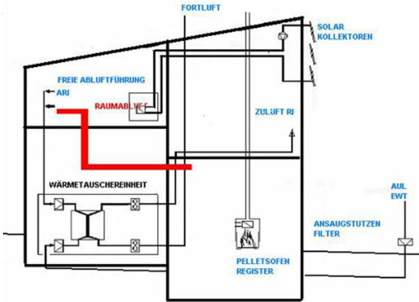
Restwärme wird über den Pelletsöfen und das Nutzen der Raumabluft in der Wärmerückgewinnung abgedeckt. Variante nur möglich bei Reduktion des Restwärmebedarfs
