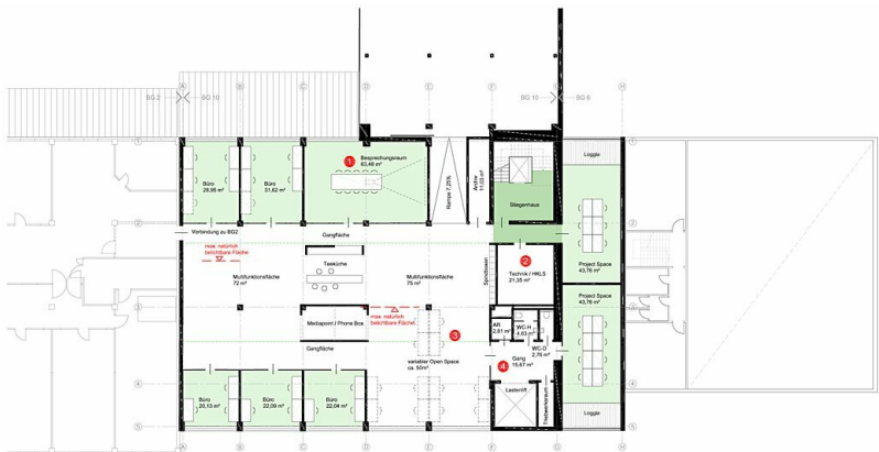
Grundriss 1.Obergeschoss M 1:200 1. Besprechungszimmer mit Präsentations- / Medien-Wand 2. Technik / HKLS Raum (optional im EG) 3. flexible Planung der Open Space / Multifunktionsflächen möglich 4. mehr Manipulationsfläche
