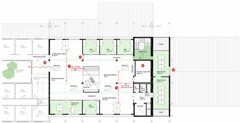
Grundriss 3.Obergeschoss M 1:200 1. flexible Planung der Multifunktionsflächen möglich 2. Position Trennwand flexibel - Flucht BG2! 3. optionale Anbindung - Belebung Dachgarten 4. Querlüftung / Panoramafenster 5. Verkleinerung zu Gunsten eines größeren Empfangsbereichs analog zu OG2 möglich
