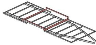
Die Stahlkonstruktion im Bereich der Radkästen dient dazu, die auftretenden Kräfte der darüberliegenden Holzkonstruktion aufzunehmen.
