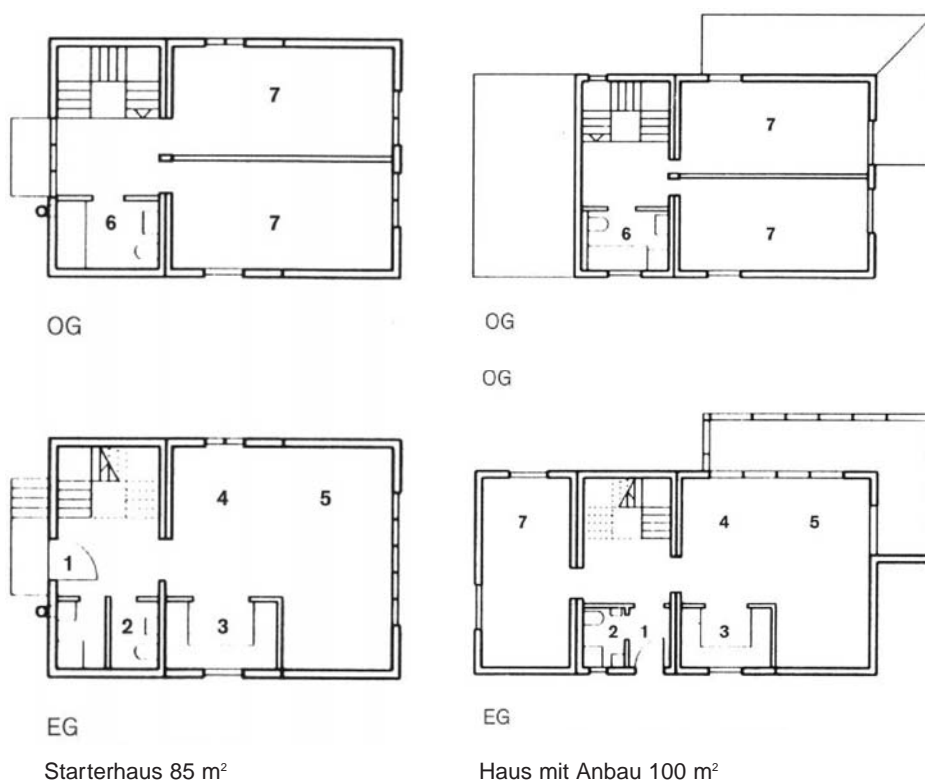
Abbildung 8. Beispiel Holzraumzellenkonzept für Kleinsiedlungen (SPP Architekten): Die Grundrisstypen basieren auf Modulen, die eine einheitliche, noch transportierbare Größe von 3 m x 6 m x 3 m aufweisen (Dworschak & Wenke 1999, 50).
