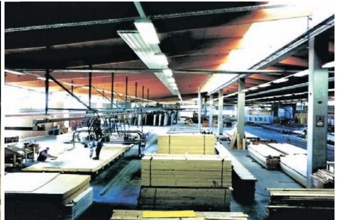
Abb. 2-4: Industrielle Vorfertigung von Tafелеlementen in Holzrahmenbauweise (Quelle: bauart)
