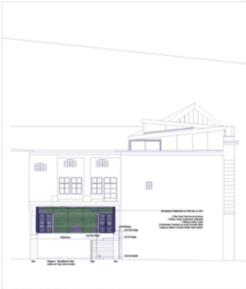
Ansicht Rankgerüst 2 mit Fassade; M 1: 100
