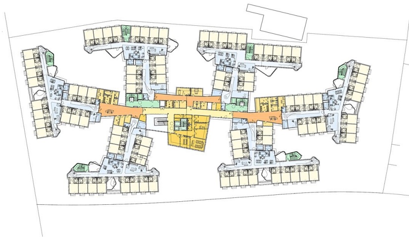
Grundriss Ebene 2-3 M 1:500
