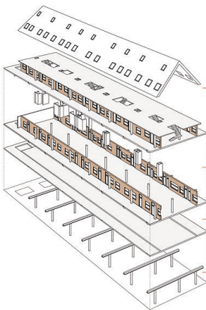
Bausystem mit Vorfertigung des gesamt Rohbaus
